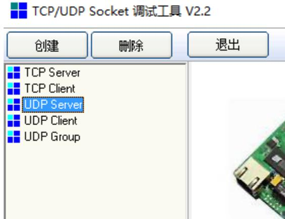
2、选中“UDP Server”，然后点击“创建”按钮，弹出如下对话框并正确输入上位机软件 SocketTool 要监听的 UDP 端口号：
