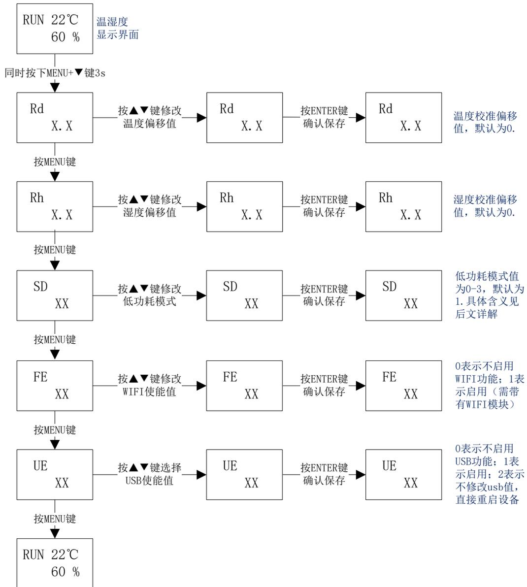
备注：1、低功耗模式值为0-3，表示外部电源切断后转为电池供电时，设备运行的功耗模式。其具体含义分别如下：
