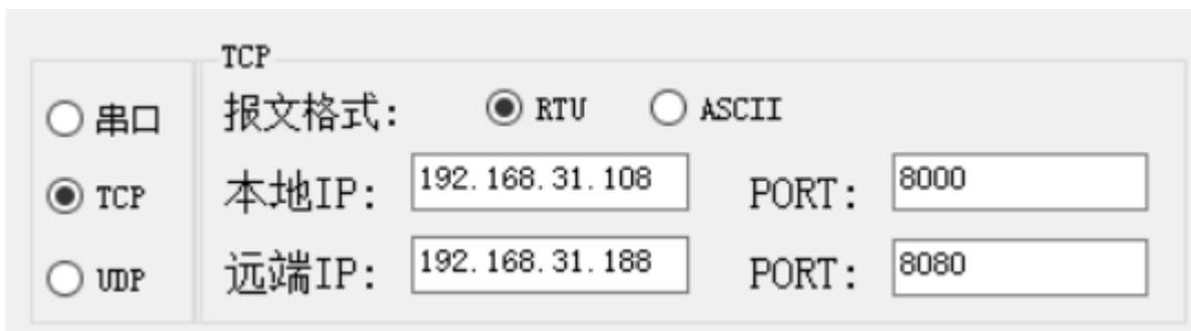
其中本地 IP 地址和 PORT 为调试管理软件所在的 PC 的 IP 地址和使用的端口号；远端 IP 和 PORT 为设备的 IP 地址和使用的端口号。
