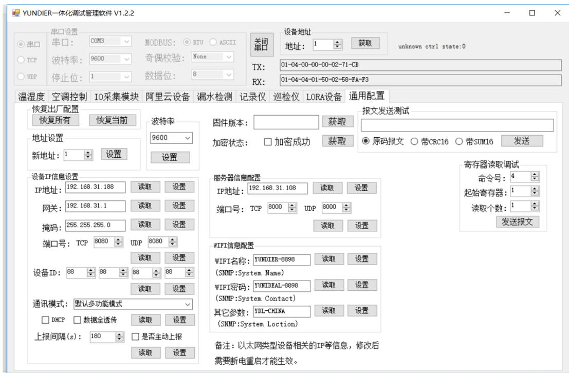
(2) 在“寄存器读取调试”栏目，输入相应的功能码、寄存器地址和读取个数，如下图所示：
