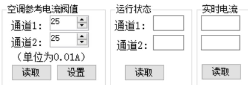
通过对空调电流的采集,可以通过电流判断当前当前空调是否处于开机运行的状态,该值设定为大于该电流时,判断空调为开机状态,否则为关机状态。
