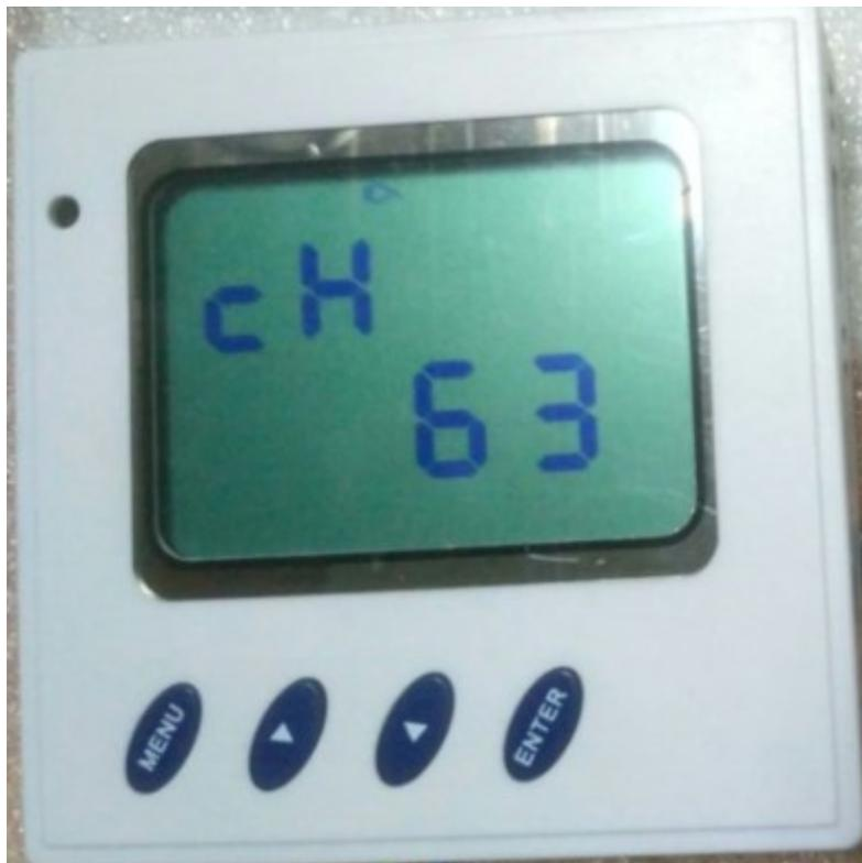
8、将空调原厂手动遥控器对准控制器屏幕左上角位置，按下按钮发送关机指令。
