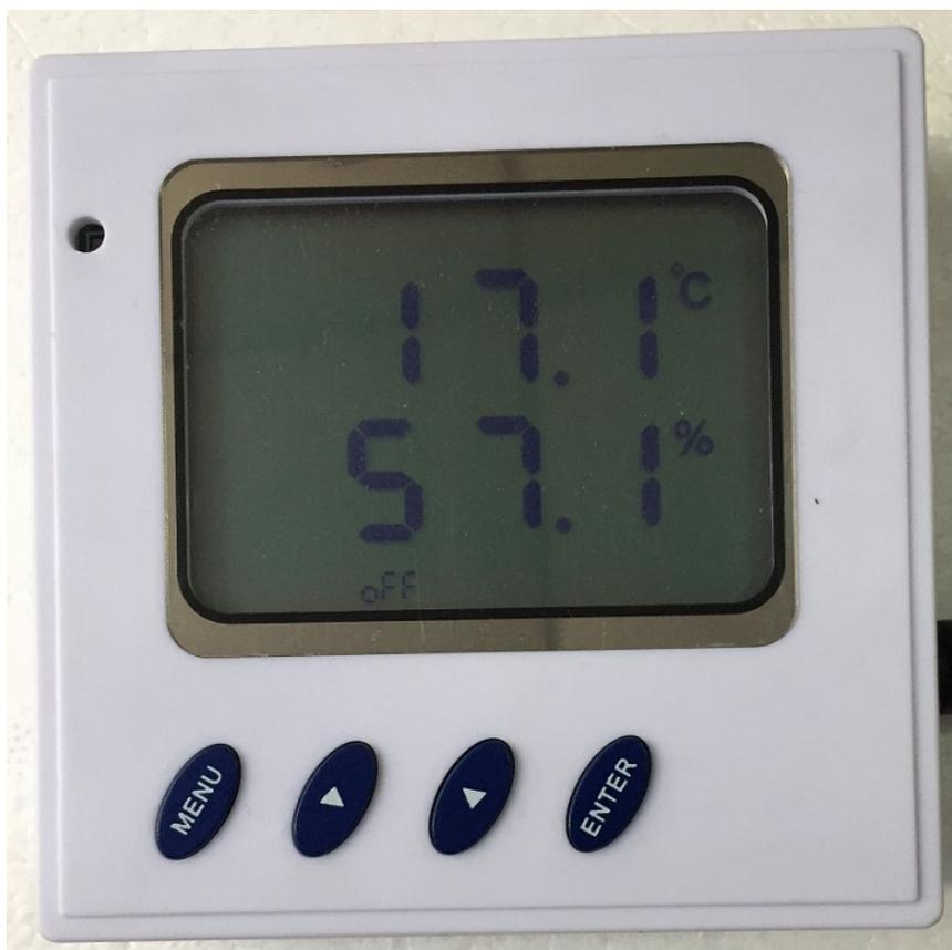
2、长按下 MENU 键（第一个键）3 秒以上，屏幕切换到显示地址界面（默认显示地址为 1，同时屏幕上方有个 wifi 的小图标提示），确认地址为 1。
