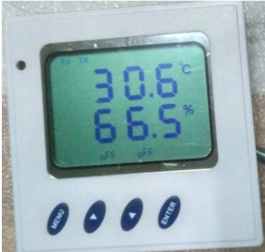
2、在温湿度显示界面，同时按下键（第三个键）和 ENTER 键（第四个键） 3 秒，屏幕切换到显示 PS 00，松开按键。（测试发送或学习功能选择界面）
